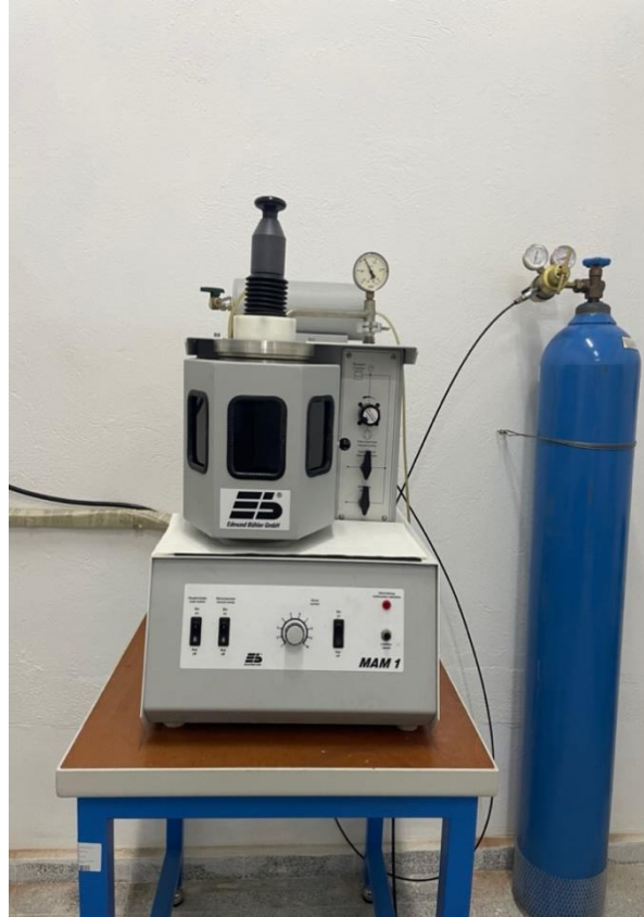
Görsel 1. Alaşımların üretiminde kullanılan ark ergitme ocağının görüntüsü
