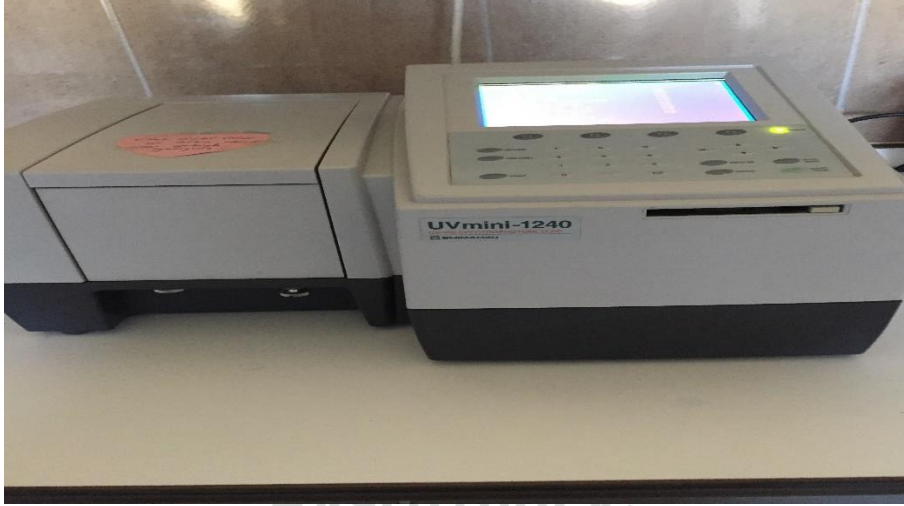
Şekil 2. Çalışmamızda kullandığımız UltraViyole -VIS mini 1240 SHIMADZU marka Spektrometre cihazı.
